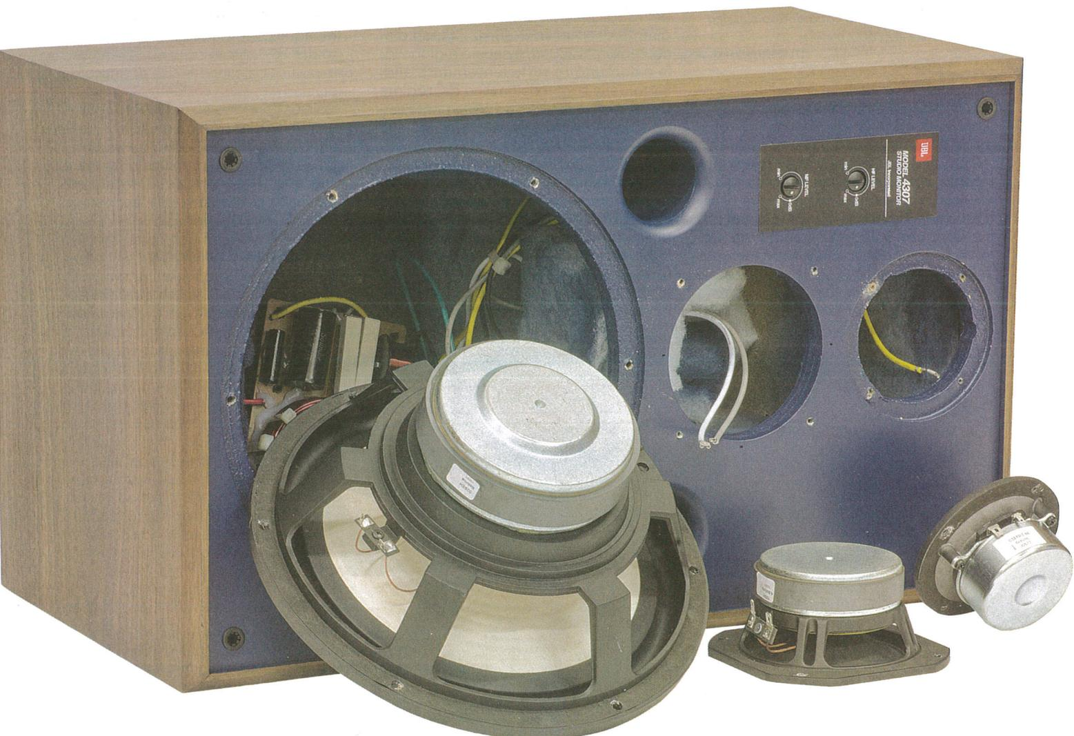
Il diffusore completamente smontato. Si vede il piccolo volume di lavoro del midrange, uno dei due condotti di accordo ed il complesso magnetico degli altoparlanti.
